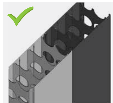
Correct – web holes align
